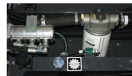
Réservoir d'huile hydraulique incorporé au châssis
